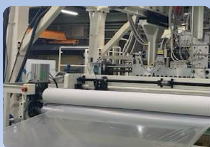
2500 毫米宽的层压单层板材成型设备安装在移动支架上的双螺杆挤压机
