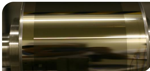
フラット-V (開き角52°)溝加工 溝深さ20 \mu m
