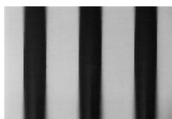
フラット-V (開き角52°)溝加工 溝深さ20 \mu m
