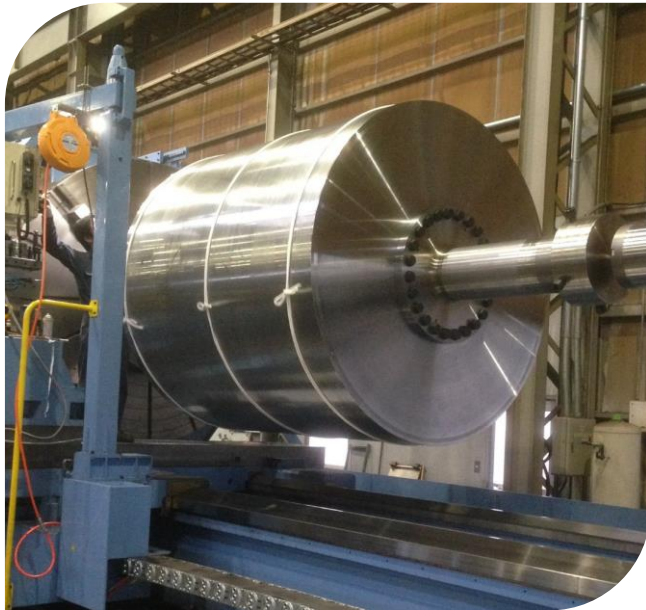
φ2000 x 2560 ワーク重量 14 t 振れ精度 25 μ 円筒度 10 μ 静バランス 1200g
