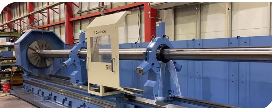
φ300 x 6000長尺ロール 内径切削加工
