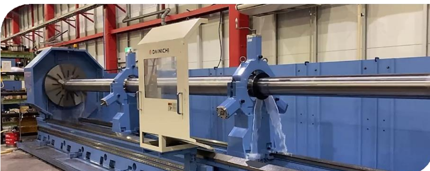
\phi 300 \times 6000 長型滾輪 內徑切削加工
