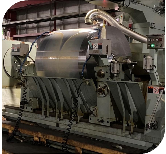
\phi 1200 \times 1200 偏擺精度 5 \mu 圓筒度 10 \mu
