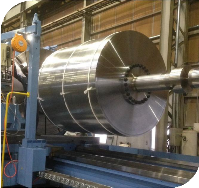
\phi 2000 \times 2560 工作重量 14 t 偏擺精度 25 \mu 圓筒度 10 \mu 靜平衡 1200g
