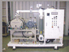
Rootsタイプ真空装置ユニット (油系用途用 水冷式、インレットセパレーター装備)
