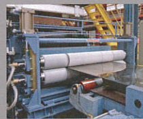
マスロールプロセスユニット (駆動系他装備)
