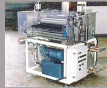
PCボード洗浄用マスロール プロセスユニット (運転制御、操作系装備)
